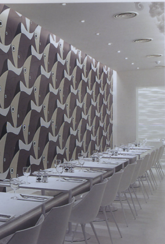
Ristorante Olivomare, Londra, architetto Pierluigi Piu. La grande parete che distingue la sala è caratterizzata da un enorme pannello in cui ogni singola porzione di colore è ritagliata al laser da fogli di laminato plastico giustapposti a formare un gigantesco puzzle. Foto P. Piu
